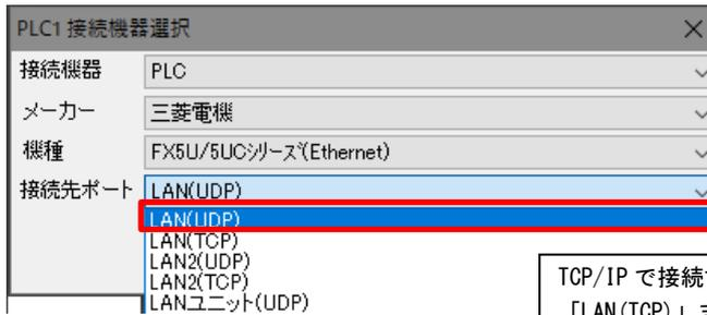
TCP/IP で接続する場合は「接続先ポート」を「LAN (TCP)」または「LAN2 (TCP)」に設定してください。
