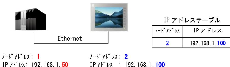
IP アドレステーブルには接続機器 (V9) を登録します。CJ1 の IP アドレスは CX-Programmer の高機能ユニット設定で、ノードアドレス No. は CJ1W-ETN11・CJ1W-ETN21 のロータリースイッチで設定します。(次項以降参照)
