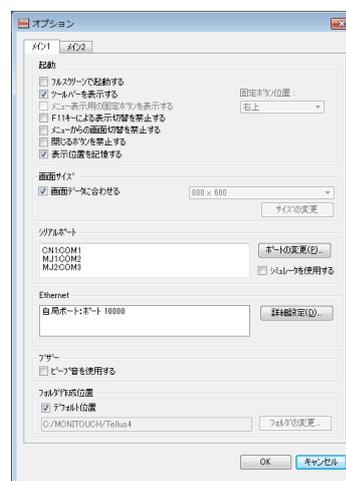
3) Ethernet 項 [詳細設定] をクリックします。「Ethernet 詳細設定」ダイアログが表示されます。
