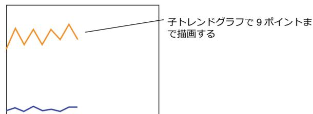
3. D140 = 5H (実行ポイント数) をセットし、D120 = 8007H (再描画クリア & 実行ポイント数) をセットする
