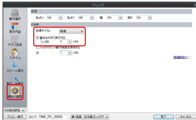
6. 親トレンドグラフ (制御デバイス D120) を子トレンドグラフ (制御デバイス D140) の下に配置し、2つ重ね合わせる
