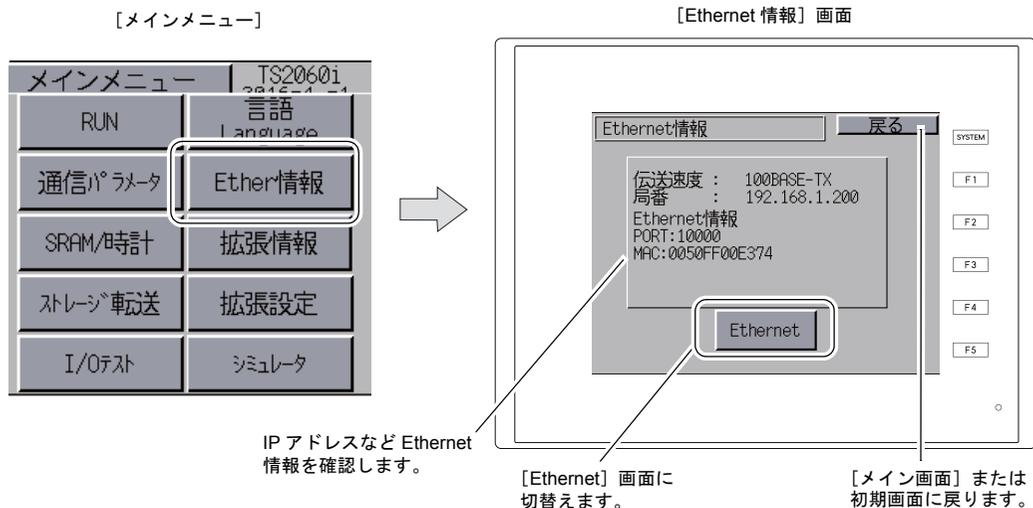
[Ethernet 情報] 画面上にある [Ethernet] スイッチを押すと、以下の画面が表示されます。TS2060i の IP アドレス設定が行えます。
