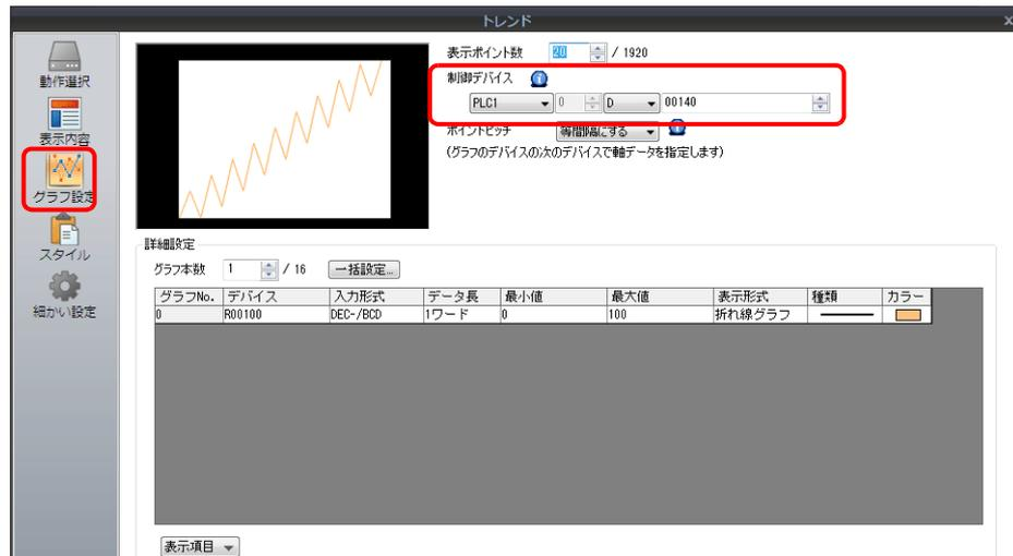
5. [細かい設定] → [処理サイクル: 高速]、[重ね合わせて表示する リンク ID : 0] に設定する (= 子トレンドグラフ)
