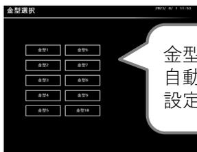
金型を選択すると、自動で周辺の温度調節計に設定値が入る仕組みに変更！
