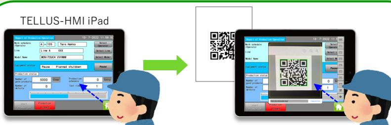
操作パネルとして使用時も作業指示票の読取り時も目線はそのまま、タブレットを見続けて作業が完了できる
