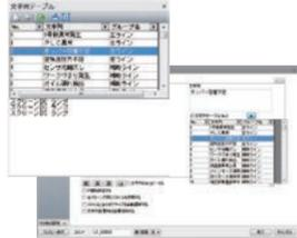
スイッチ、ランプをはじめとした各種パーツに表示するテキストを一元管理する文字列テーブルを採用。使用頻度が高い文字を文字列テーブルに登録しておけば、テーブルから参照・指定するだけで文字の登録が完了します。変更が発生した場合にも文字列テーブルの変更だけで一括変更できます。
