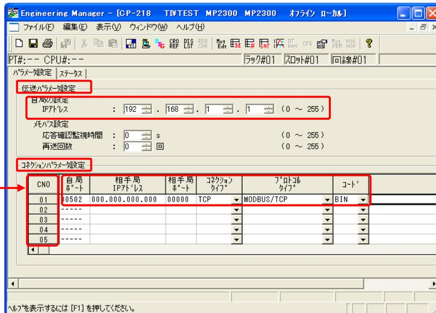
接続 No. : MSG-RCV 関数で使用します。
